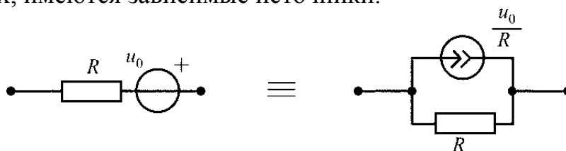
Рис. 2.8. Преобразование ветви с источником напряжения и резистивным сопротивлением в эквивалентную схему с источником тока
