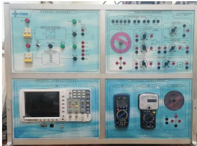
Рисунок 4.1 - Общий вид учебно-исследовательского комплекса «Потенциометрическая маломощная следящая система»
