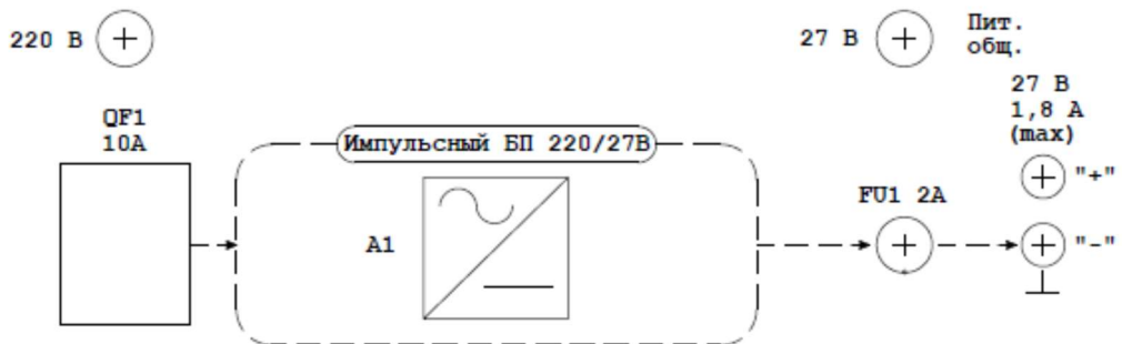
Рисунок 4.5 - Импульсный блок питания 220/27 В (схема расположения элементов)
