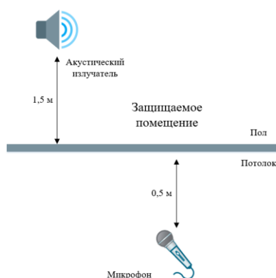
Рисунок 4.11 – Схема размещения датчиков при измерениях перекрытий пола и потолка
