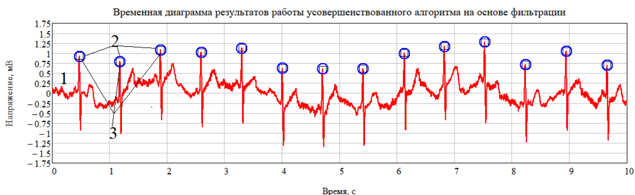
Рисунок 3.9 – График результатов обнаружения ЭКК алгоритмом на основе цифровой фильтрации ( f_{\text{дискр}}=1000 Гц, K_C=5/3 , C_i=10 ) на промежутке [0;10] с
