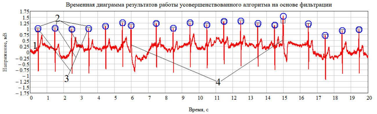
Рисунок 3.11 – График результатов обнаружения опорных точек ЭКК на основе цифровой фильтрации на промежутке [0;20] с
