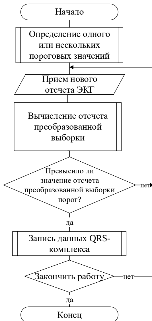
Рисунок 3.2 – Обобщенная блок-схема алгоритмов обнаружения QRS -комплексов на основе преобразования выборки ЭКГ
