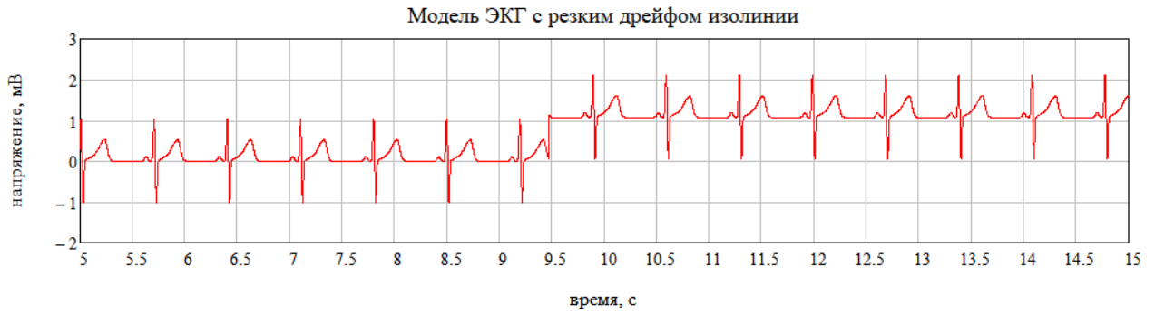
Рисунок 2.10 – Временная диаграмма модели сигнала с резким изменением уровня изолинии, вызванным смещением электродов, на промежутке [5; 15] с
