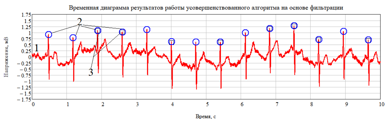
Рисунок 3.10 – График результатов обнаружения ЭКК алгоритмом на основе цифровой фильтрации ( f_{\text{дискр}}=1000 Гц, K_C=2 , C_i=10 ) на промежутке [0;10] с
