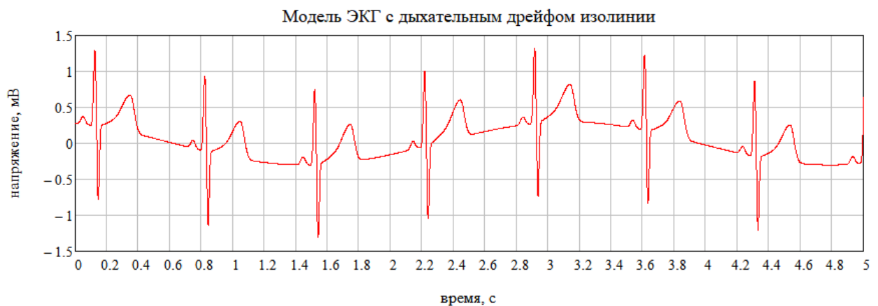
Рисунок 2.8 – Временная диаграмма модели полезного сигнала с дыхательным дрейфом изолинии с частотой 0.3 Гц на промежутке [0; 5] с
