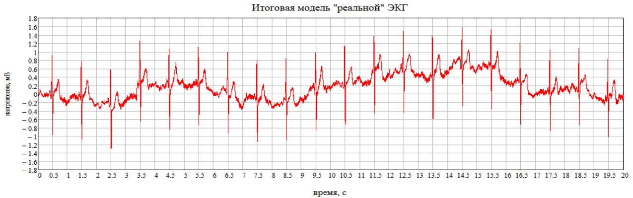
Рисунок 2.11 – Временная диаграмма модели сигнала, искаженной совокупным сигналом помехи
