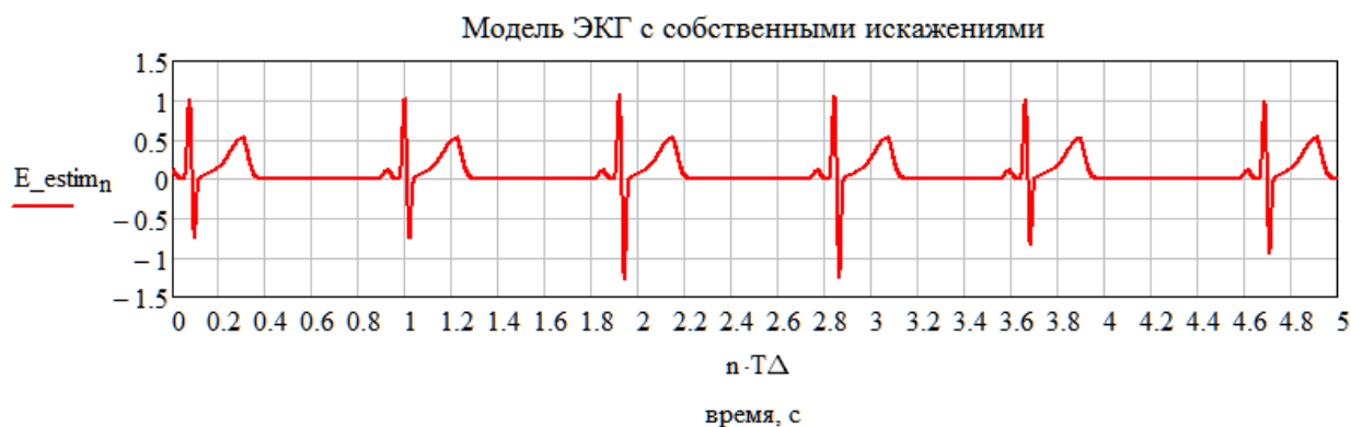
Рисунок 2.4 – Временная диаграмма полезного сигнала, полученного в результате компьютерного моделирования, на основе параметров первого ЭКК записи №16795 базы данных MIT-BIH Normal Sinus Rhythm Database
