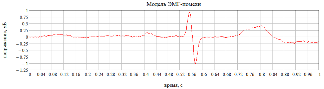
Рисунок 2.7 – Временная диаграмма модели полезного сигнала, искаженной сигналом ЭМГ-помехи с параметрами корреляционной функции \sigma=0.1 , \mu=1.5 на промежутке [0; 1] с
